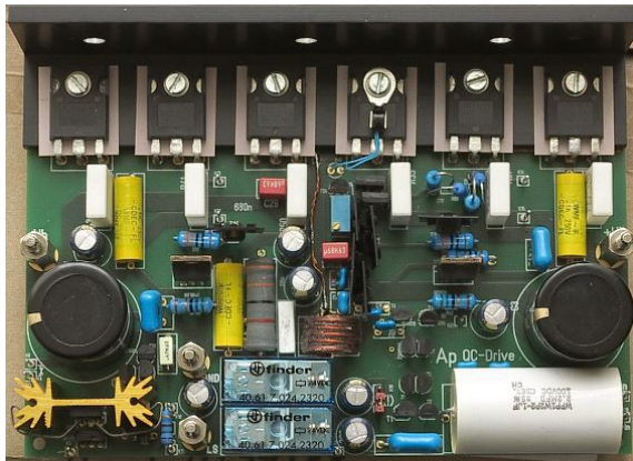
QC-DRIVE-TRANSKONDUKTANZ-ENDSTUFE (vorläufige Version) mit 6 Endmosfets s. Seite "Service", pdf QC-Amp
